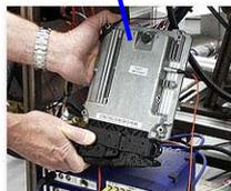
**robuste** Computer (Motorsteuergerät)
